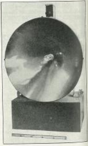
Fig. 2. — Le générateur d'ondes ultracourtes monté au foyer d'un miroir réflecteur parabolique.
